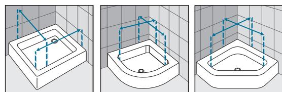
Rilevare le misure da muro a bordo interno del piatto doccia. Le misure devono essere rilevate sulla parete finita, a rivestimenti posati, secondo gli schemi riportati.
